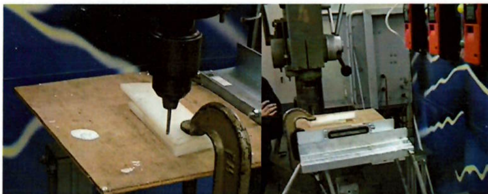
Figuras 34 e 35: Fresamento em nylon
