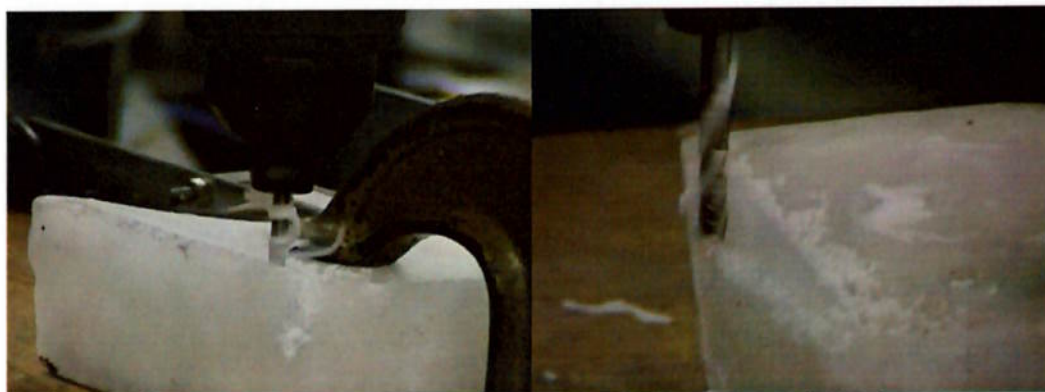
Figuras 32 e 33: Fresamento em parafina
