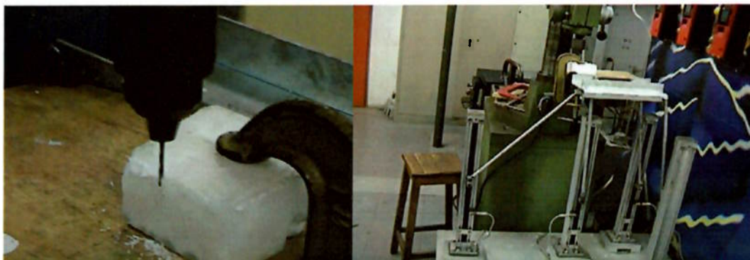
Figuras 30 e 31: Fresamento em parafina
